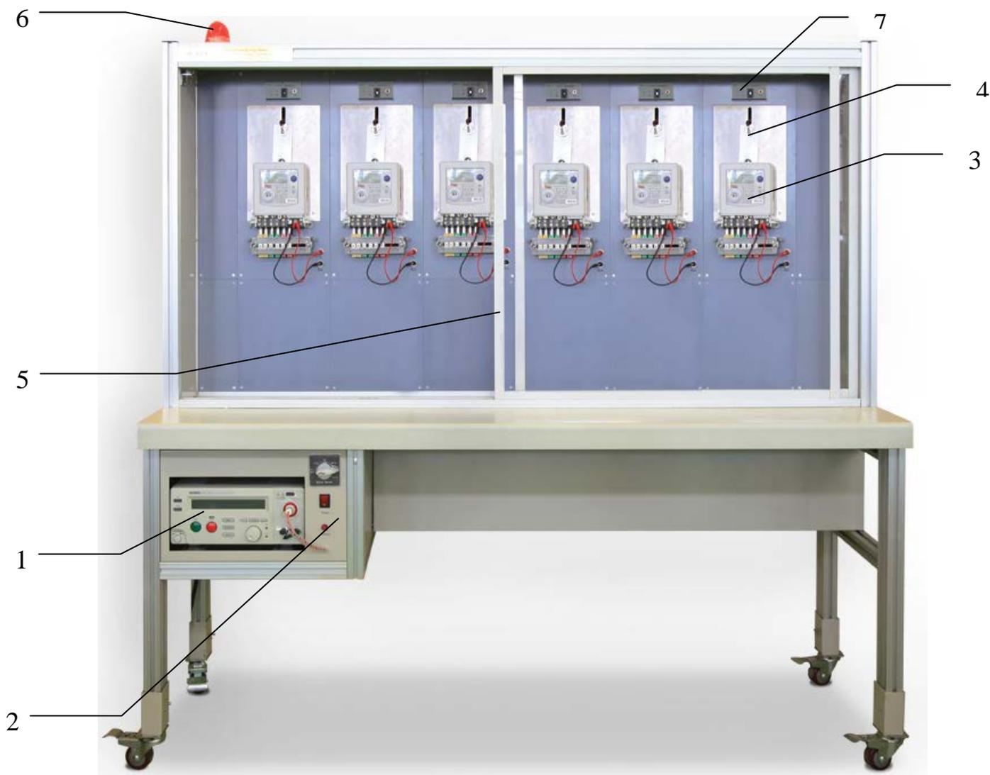
1 - Прибор для проверки параметров электрической безопасности серии GPT/GPI-700A, 2 - Панель управления Установкой НЕВА-Тест, 3 – проверяемый счетчик, 4 - посадочное место проверяемого счетчика подпружиненным контактирующим устройством, 5 – защитные шторы, блокирующие подачу напряжения питания, 6 – индикаторная лампа работы Установки, 7 – Панель состояния проверяемого счетчика.
