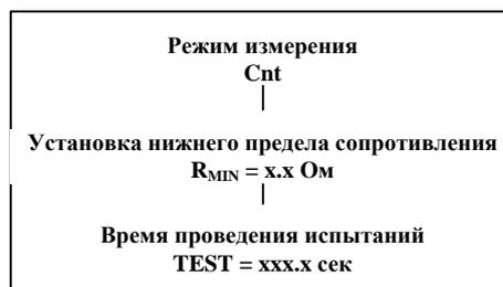
Нажмите кнопку «FIELD» для перехода в режим коррекции верхнего предела измерения сопротивления. Используя кнопки «<-», «->» выберите разряд, в котором будет проводиться коррекция, вращающейся ручкой установите необходимое значение сопротивления (сопротивление может находиться в пределах 0 ... 1,2 Ом).
